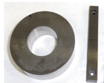
摩擦試験で使用した金属試験片
