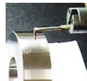
摩擦試験のイメージ(金属試験片を圧接し、油を垂らしながら回転させる)
