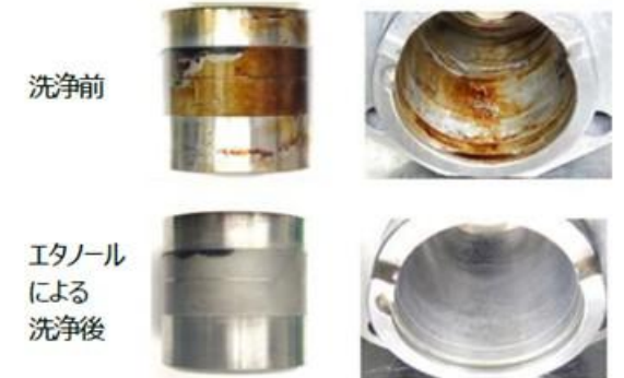
図 12 フランジガイドとポンプ本体
